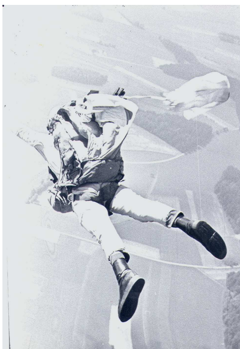
Ouverture avec une static-line (à l'américaine) et sortie de l'extracteur d'un parachute Switlick C-9 avec gaine sur la voile Principe sortie suspendes d'abord.
