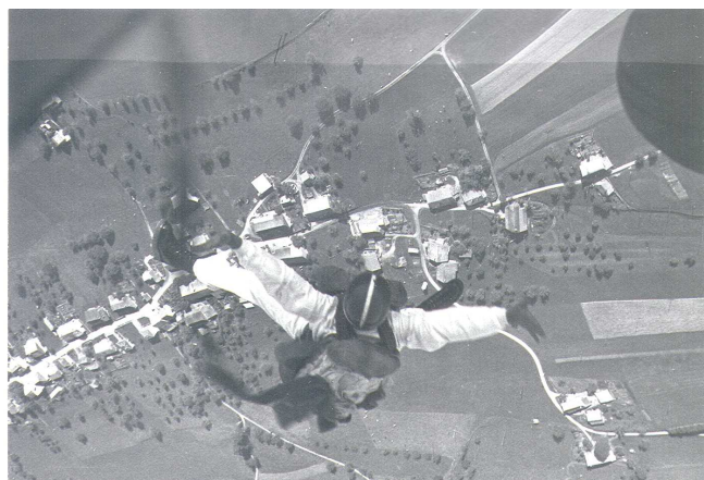
Ouverture d'un TAP 660 français par l'extraction immédiate de la voile par une sangle d'ouverture Automatique (SOA) Principe sortie voile d'abord.
